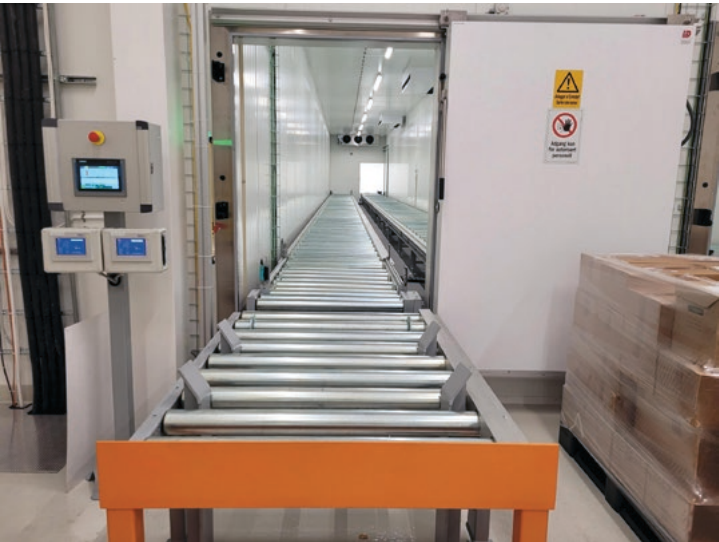
→ I kjølelageret blir innkom- met materiale fryst noen dager i -30 °C. Deretter fines materialet langsomt opp. Hele prosessen tar en uke. Foto: Jan Inge Larsen / Nasjonalbiblioteket.
