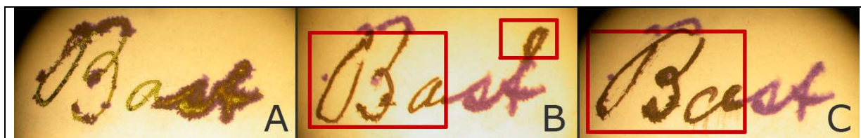
Fig. 4 Fra venstre eks. A, B og C, tekst fra side 185. I det første bildet til venstre ser man grøntskinnende blekk som delvis er løst opp og som har skilt ut anilinfargen i "...st" både til gelatinet og ut i papiret. Områder som ikke var løst opp ble ikke kopiert, og måtte dermed rettes opp til "Ba..." for hånd, slik man ser det her i eks. B og C i sort blekk. Foto: Nasjonalbiblioteket.
